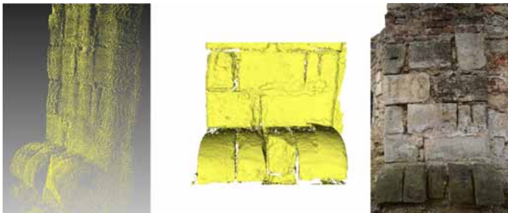
Ryc. 2. Fragmenty bramy wjazdowej zamku górnego w Iłży. Pomiar przestrzenny – tzw. chmura punktów, model mesh oraz fotografia skanowanego fragmentu (oprac. R. Zapłata).
